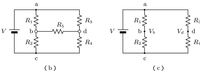
図 47. ブリッジ回路の  $R_5$  に流れる電流  $I$  の解析
