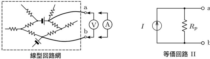
つまり、等価回路 II の定電流電源の電流値  $I$  と並列抵抗値  $R_p$  を決めれば、図左の複雑な回路は忘れて、図右の簡単な等価回路 II を考えればよい。
