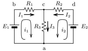
図 48. 電池 2 個の回路
