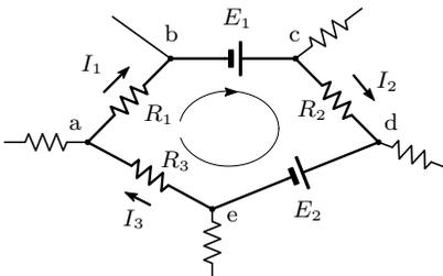
図 32. 回路中の閉回路
