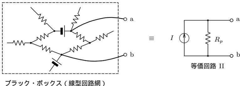
図 42. 定電流電源等価回路 (等価回路 )
