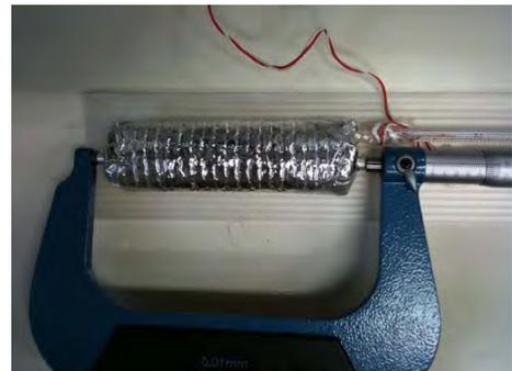
FIG. 2: アルミ棒の長さ測定。
