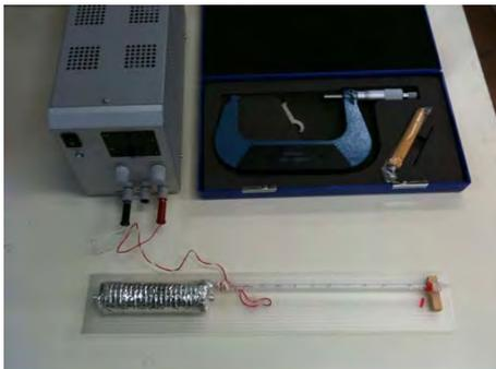
FIG. 1: 直流電源、マイクロメータ、アルミ棒と温度計。
