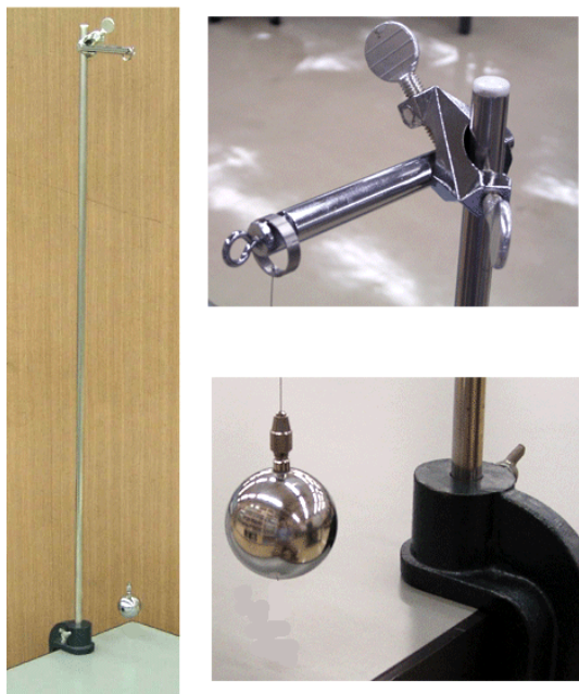
FIG. 2: 全体像と細部。銅線はチャックを使って、錘に固定する。また、振動の支点にはリングを使用する。横棒は机上面からの高さを 1 m の物差しで測定できる最高の高さに固定する。その際、横棒の角を上向きにすること。
