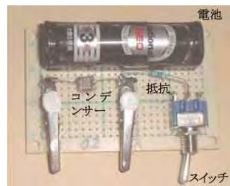
FIG. 2: コンデンサーの充放電の測定回路
