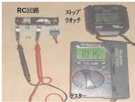
FIG. 3: コンデンサーの充放電の測定回路。テスターは直流電圧測定モードにすること。
